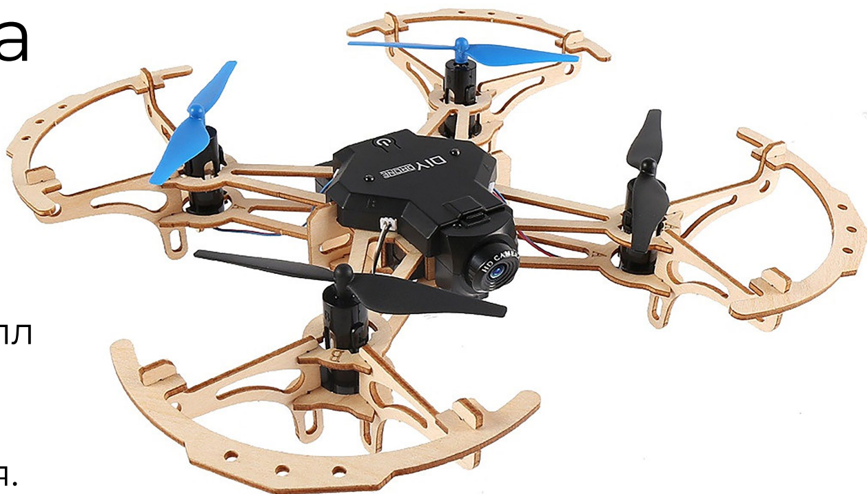
Пример объёмного изделия: корпус квадрокоптера из фанеры.
